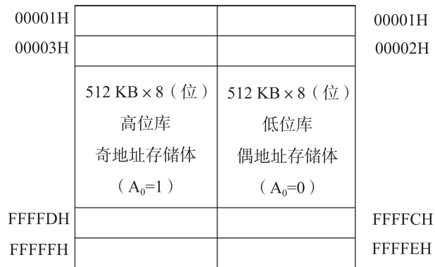
图 2-10 8086 存储器的分体结构
